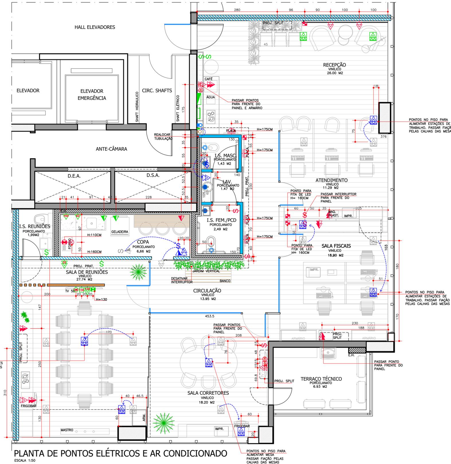
**PLANTA DE PONTOS ELÉTRICOS E AR CONDICIONADO**
