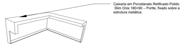
Caixaria em Porcelanato Retificado Polido Slim Onix 180x90 - Porte, fixado sobre a estrutura metálica.
