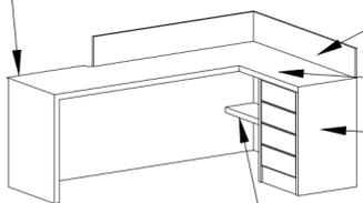
Painel de acabamento em MDF 15mm sobre a bancada isolando a estrutura metálica.
