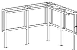
Estrutura metálica em tubos de 40x40mm fixados ao chão com chumadores, adjacente ao módulo do balcão, onde será fixado o revestimento em Porcelanato.
